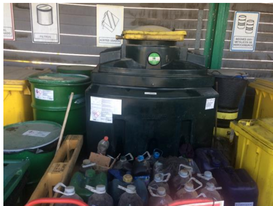
Figura 15: Contenedor de aceite de motor rodeado de garrafas de agua de sentina del punto limpio de Carboneras.
