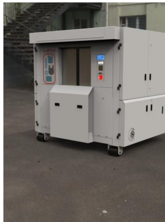
Figura 30: Ejemplo de contenedor compactador con control de acceso del usuario empleado en otros puertos europeos.
