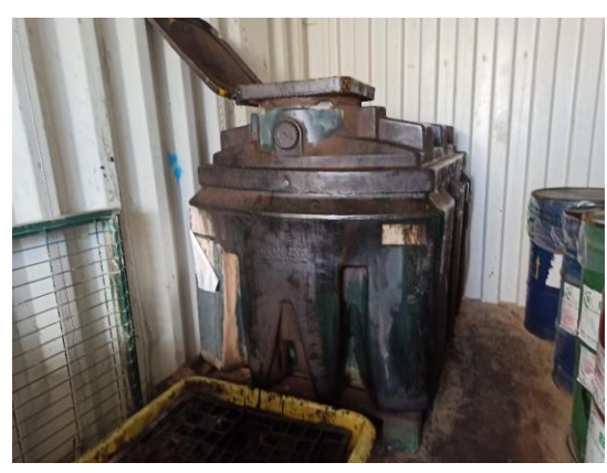
Figura 23: Contenedor de MARPOL I del punto limpio del puerto de Morro Jable.
