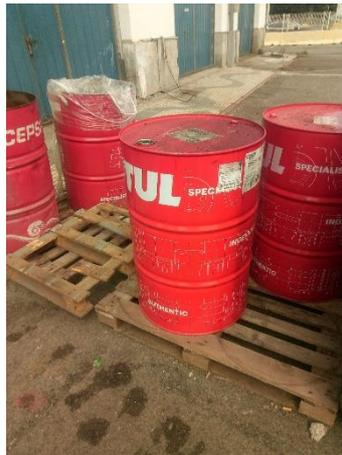
Figura 9: Bidones para la recogida en autoservicio de residuos MARPOL I.
