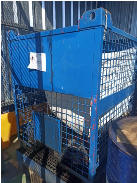
Figura 22: Estructura para big bag para envases de residuos peligrosos en el puerto de Valencia.
