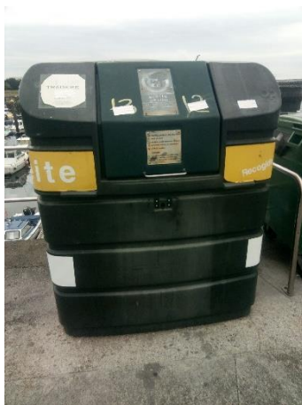
Figura 5. Contenedor de aceite usado en el puerto de Zierbena (País Vasco). Estos contenedores pueden tener una segunda boca para depositar los residuos sólidos con aceite, como filtros o paños absorbentes.
