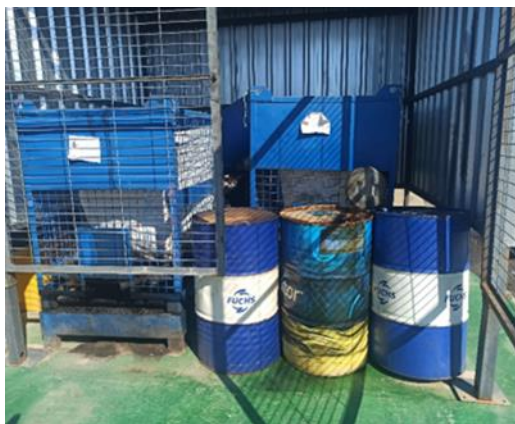
Figura 10. Recipientes del punto limpio del puerto de Valencia. Las estructuras grandes metálicas son para la colocación de big bag donde depositar recipientes contaminados.
